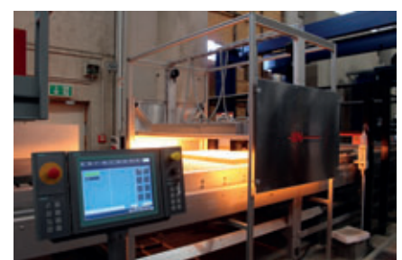
Aushärtung des Schutzlacks unter UV-Licht
