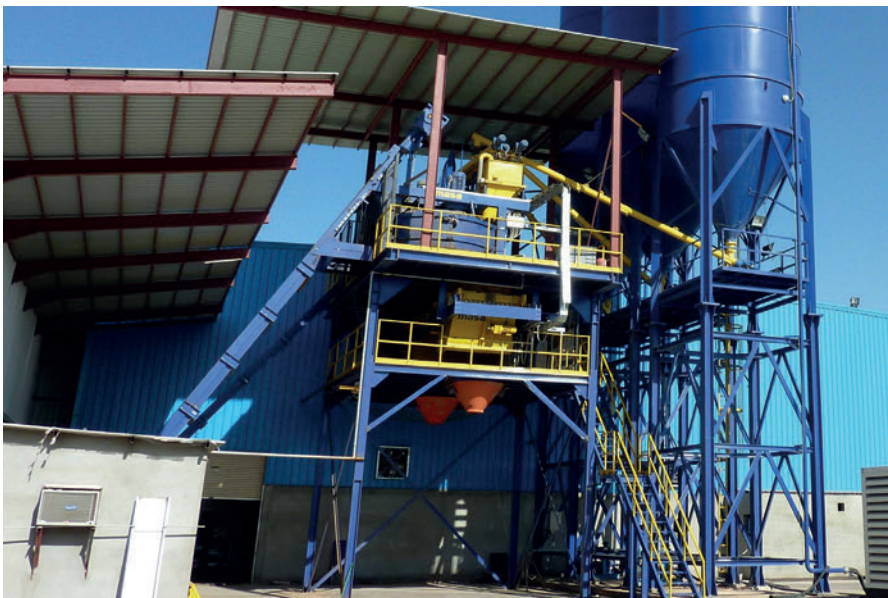
Башенный смеситель Masa: шнековые питатели подают цемент на специальные весы смесителя Masa S 350/500 и PH 2000/3000
