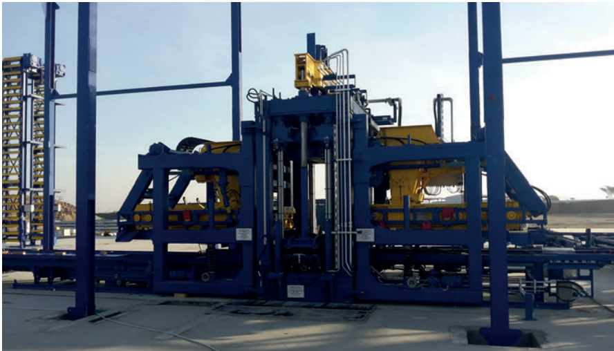
Машина для производства бетонных блоков Masa XL 9.2 – передовые немецкие технологии
