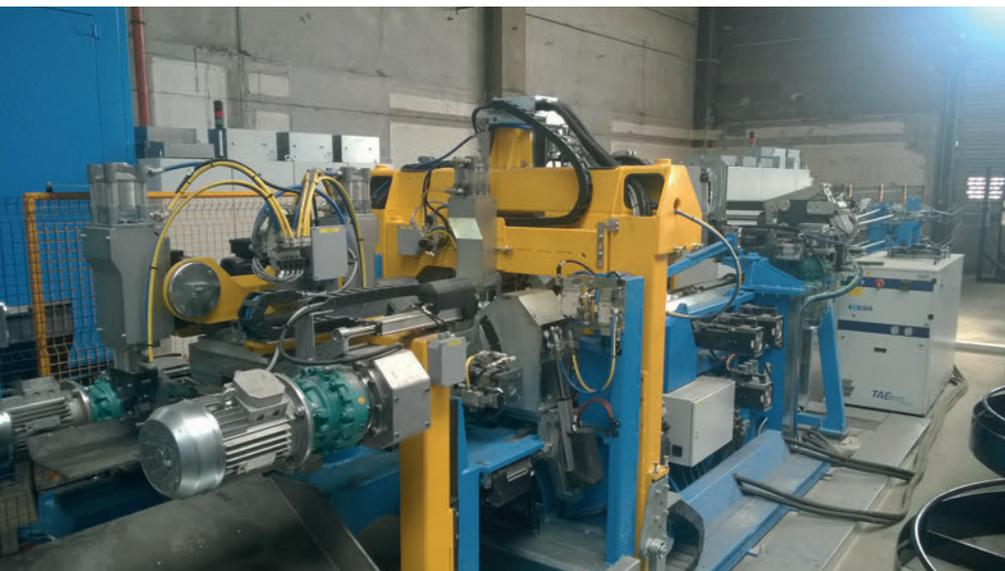
Машина для сварки треугольных арматурных каркасов VGA Versa
