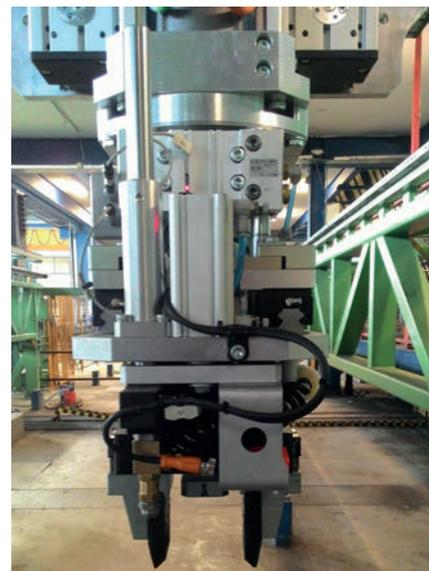
Головка опалубочного робота
