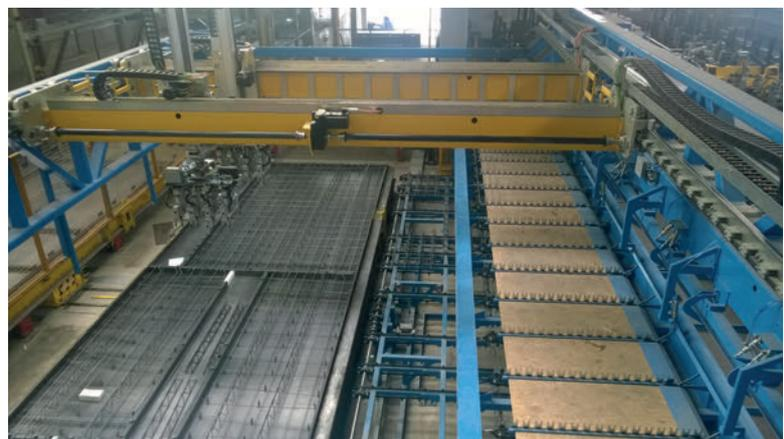
Wire Center: автоматическая роботизированная система укладки арматуры
