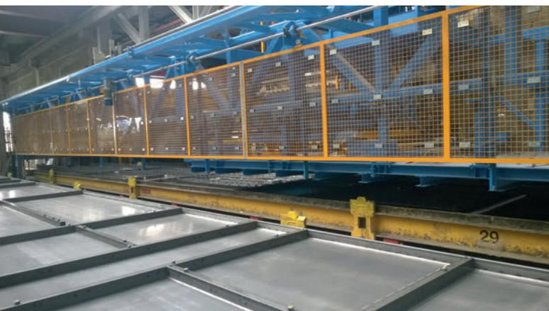
Принцип сантиметрового шага: опалубивание без зазоров и пенополистироловых вкладышей
