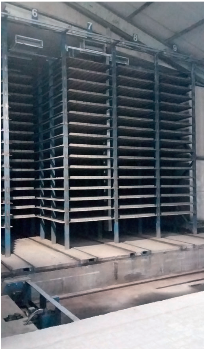
Приточный воздушный канал над проходом № 7 направляет теплый воздух в зону транспортной группы для поддержания температуры во всей камере на стабильном уровне при погрешности +/- 1 °C
