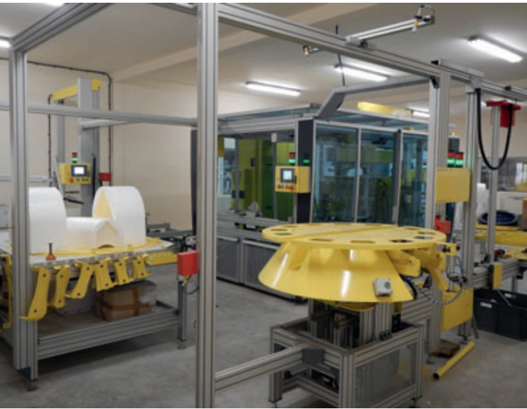
Le taglierine a filo incandescente computerizzate realizzano tagli di massima precisione degli stampi per i negativi dei canali.
