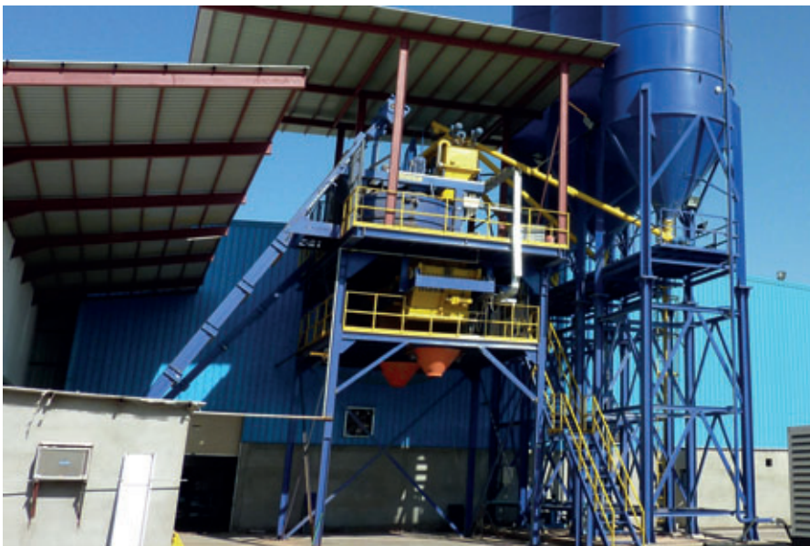
Vista sulla torre di betonaggio Masa. Ciascuna coclea convoglia il cemento in una bilancia per il cemento dei miscelatori Masa S 350/500 e PH 2000/3000
