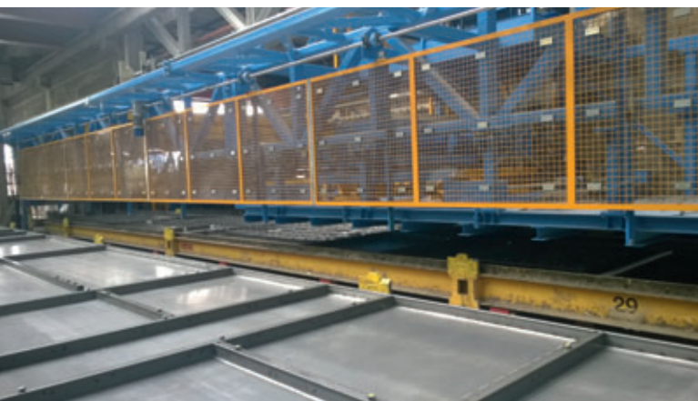
Principio della cassaforma a reticolo centimetrato: una cassetatura continua senza elementi di riempimento
