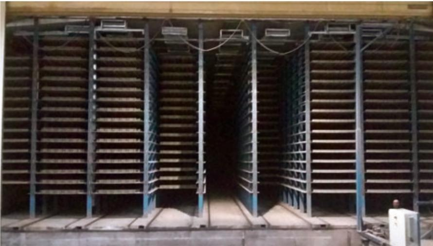
Les canaux d'alimentation et de retour galvanisés sont installés au-dessus du système de rayonnages. Ils ne prennent ainsi pas de place. Dans chaque allée, de devant jusqu'au fond, le sol reste sec, avec une humidité de l'air de 95 %.
