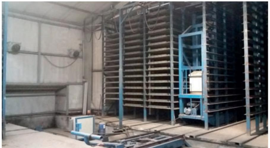
Grâce à la circulation d'air dans les allées, cette zone reste sèche, tout comme le chariot transbordeur et il ne se forme pas d'eau de condensation au niveau du plafond, ni de brouillard, qui pourrait conduire à une possible perte de la mesure par laser des trajets réalisés par le chariot transbordeur.
