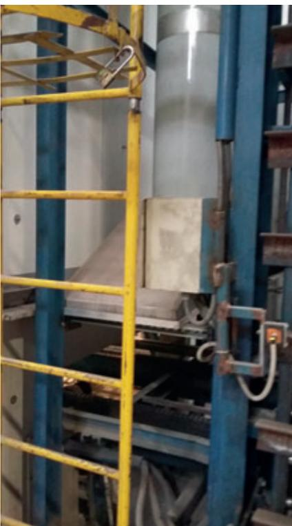
L'une des deux hottes chauffées, installée entre le descenseur et la cloison extérieure de la chambre, empêche tout échappement d'air chaud et humide hors de la chambre de durcissement et empêche ainsi que des gouttes d'eau de condensation ne tombent sur les pavés frais.
