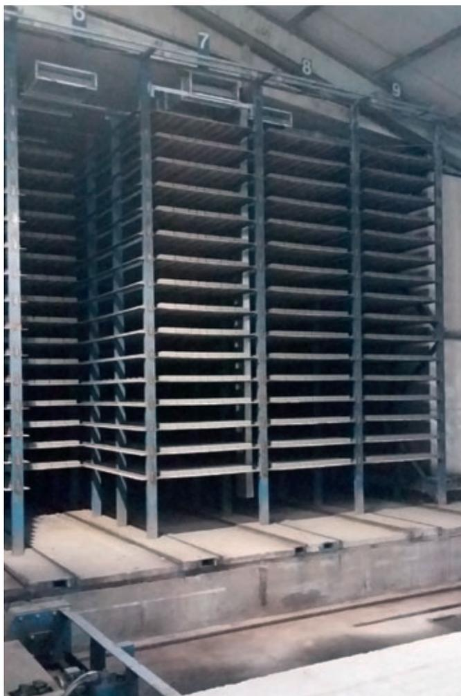
*Le canal d'amenée d'air situé au-dessus de l'allée n° 7 commande l'air chaud dans la zone du chariot transbordeur, de façon à maintenir la température constante, à  $\pm 1$  °C, dans l'ensemble de la chambre, même dans la zone du chariot transbordeur.*
