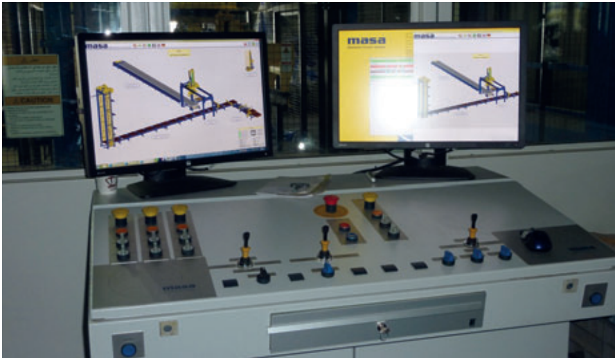
Tout est sous contrôle en permanence grâce au logiciel de commande d'installation modulaire Masa Fast
