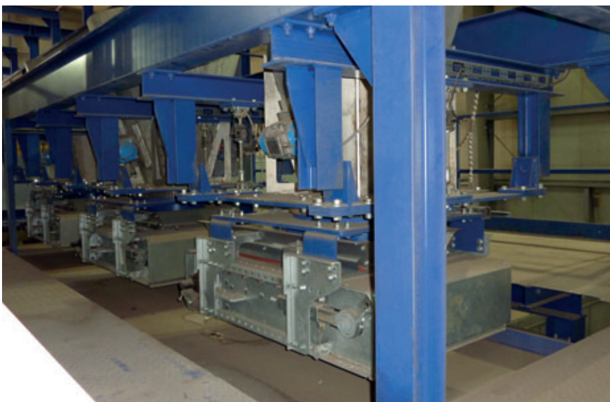
Les bandes transporteuses peuvent être pivotées d'environ 30° vers la gauche ou vers la droite depuis leur position médiane pour le dosage du béton coloré
