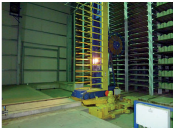
Le chariot élévateur de Masa dans la chambre de durcissement avec système d'étagères Rotho
