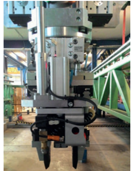
Tête du robot de coffrage
