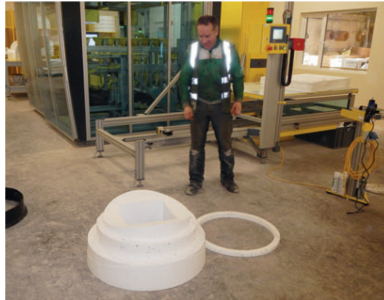
Une réservation pour branchements de tuyaux, réalisée en EPS (mousse dure de polystyrène) sur mesure pour les dimensions requises.
