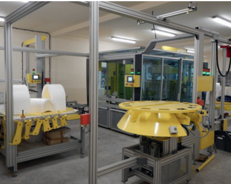
Des scies à fil chaud pilotées par ordinateur garantissent une découpe exacte des matrices pour le négatif de cunette souhaité.
