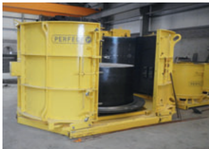
Tracey Concrete fabrique des fonds de regards sur mesure, en diamètre 1800 mm, grâce aux matrices en EPS.
