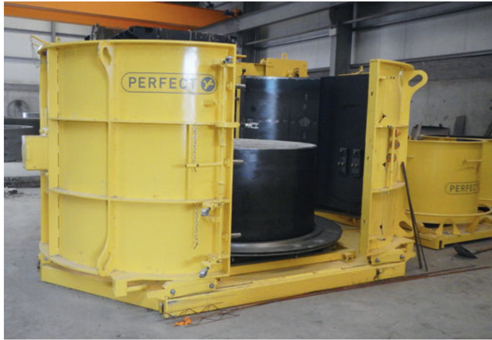
Con un diámetro de 1800 mm, Tracey Concrete fabrica bases de pozos de hormigón a medida utilizando moldes de EPS.
