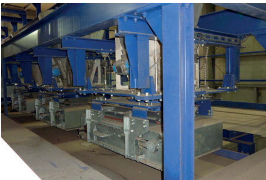
Las cintas transportadoras pueden bascular durante la dosificación del hormigón coloreado en aproximadamente 30 grados hacia la izquierda o la derecha desde la posición central
