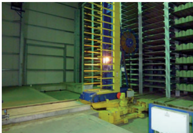
Carro multiforca Masa en la cámara de curado con sistema de estanterías Rotho
