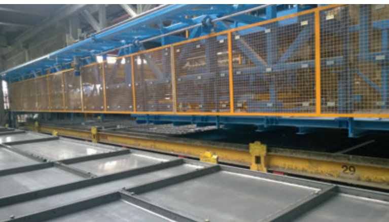
Principio de encofrado con precisión al centímetro: encofrado sin espacios libres y sin elementos de relleno
