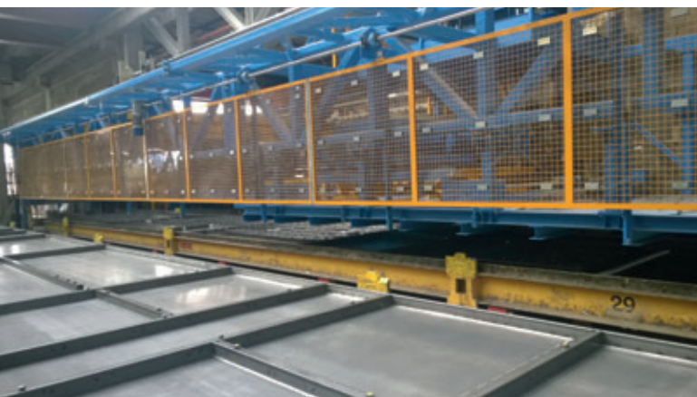
Prinzip der Zentimeterschalung: lückenfreies Schalen ohne Füllelemente
