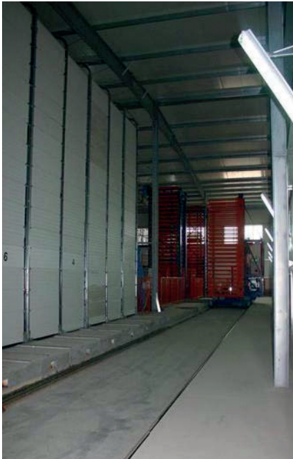
2011 г. – Транспортировочный участок с 11 камерами выдержки и теплоизолированными воротами
