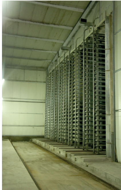
2015 г. – отдельные камеры выдержки с транспортировочной зоной и открытой стеллажной зоной для выдержки при 30°C и 90%
