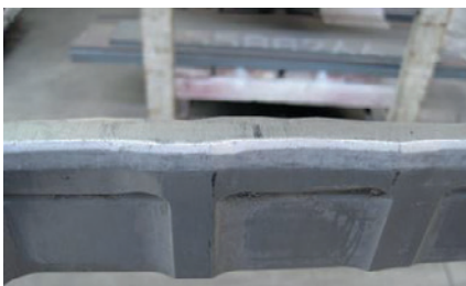
Рис. 5: Сильный износ на верхней кромке формы
