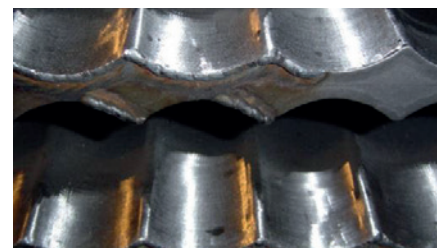
Рис. 2: Наплавка на нижнюю кромку формы: до и после
