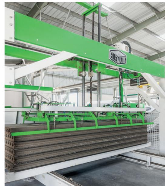
Панели Acotec подходят для различных целей: обладая отличной звукоизоляцией (RW 38 – 48 дБ), они успешно используются при строительстве многоквартирных зданий, школ и отелей, а их влагостойкость позволяет применять их в ванных комнатах, кухнях и санузлах
