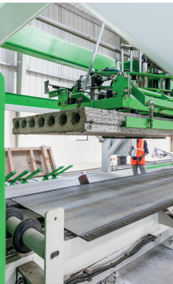
Линия Elematic Acotec предназначена для производства легких несущих бетонных перегородок. Линия позволяет осуществлять весь производственный процесс от приготовления бетона до хранения изделий
