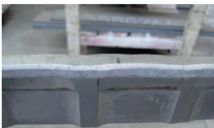
Figura 5: Forte usura sullo spigolo superiore dello stampo
