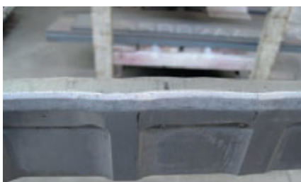
Figure 5 : Usure importante du bord supérieur du moule
