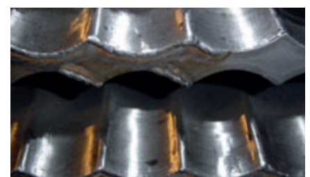
Figure 2 : Rechargement des arêtes du bas de caisse du moule, avant et après
