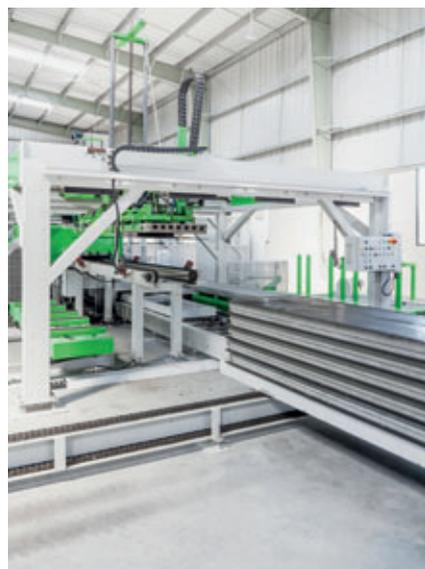
*Les lignes de production de cloisons Acotec disposent d'un nouveau système pionnier en termes de commande de production, avec une interface utilisateur simple et moderne présentant les données détaillées des fonctions de l'ensemble du processus. Différents rapports - quantité de production, heures de fonctionnement et d'autres encore - sont générés automatiquement.*
