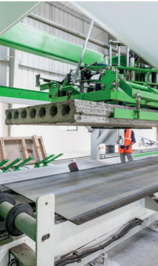
Les lignes Acotec de la société Elematic servent à la fabrication de panneaux de cloisons à hauteur de plafond, légers et non porteurs. Elles couvrent l'ensemble du processus de production, depuis la fabrication du béton jusqu'à la gestion des emplacements de stockage.
