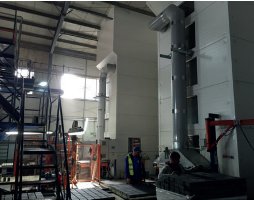
Quadrix 300-150 Calefacción y unidad de circulación del aire con campana extractora Nautilus™
