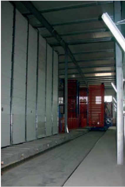
2011 – Zona de transporte con 11 cámaras de curado y portones aislados
