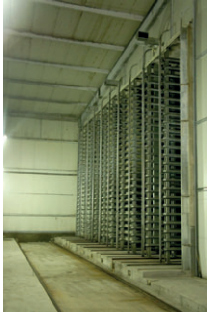
2015 – Cámaras de curado individual con zona de transporte y zona abierta de curado en estanterías a 30°C y 90%.
