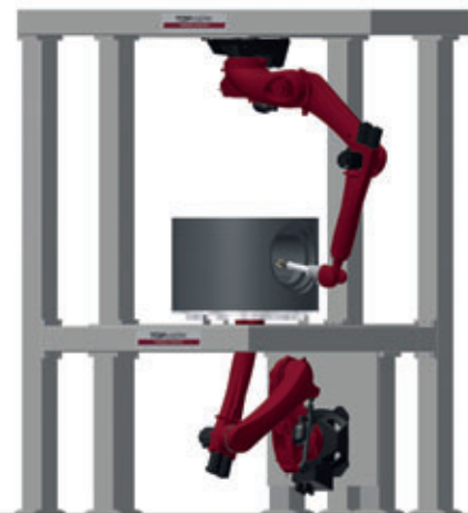
Estaciones de fresado doble con 2 robots de fresado (un robot dispuesto por encima de suelo, un robot bajo suelo)
