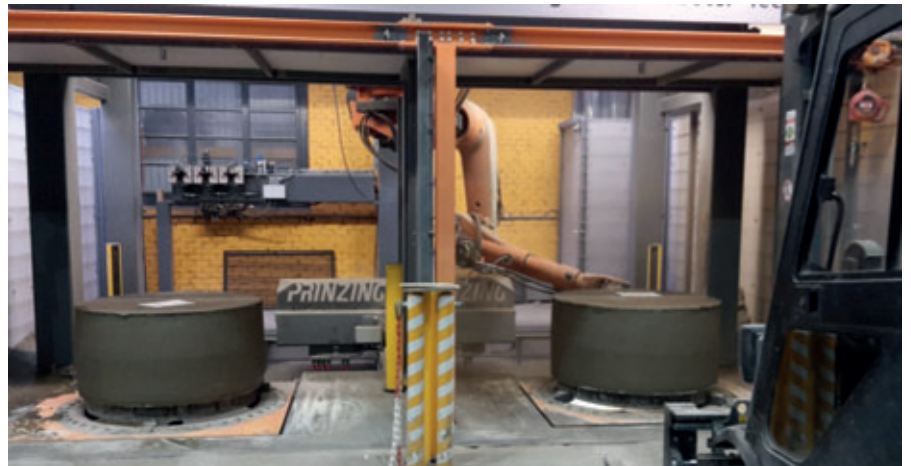
Estaciones de fresado doble con 2 robots de fresado (un robot dispuesto por encima de suelo, un robot bajo suelo)
