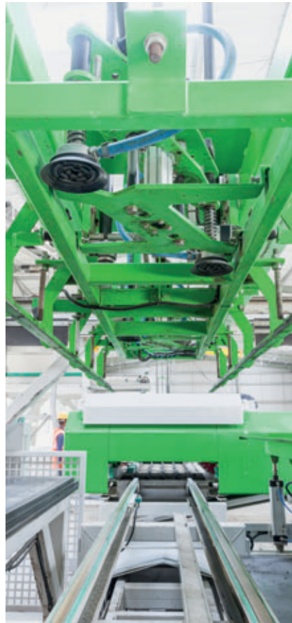
Die modulare Bauweise der Acotec Linien und die integrierte Elektrik mit Ethercat-Bus garantieren kurze Installations- und Inbetriebnahmezeiten für alle Linien.
