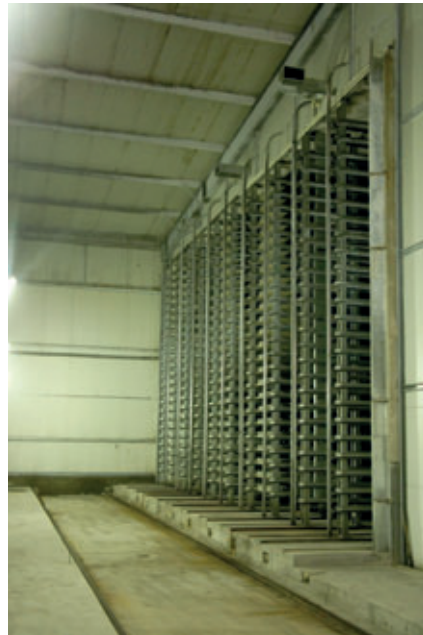
Einzelhärtekammer mit Fahrzeuggruppenbereich und offener Regalhärtungsanlage bei 30°C und 90%.
