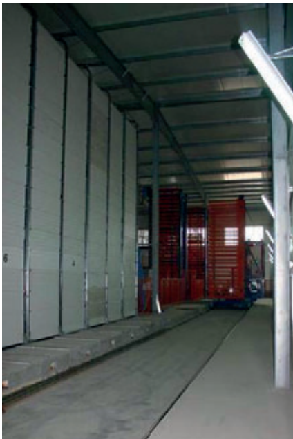
2011 – Transportbereich mit 11 Härtekammern und isolierten Toren
