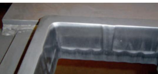
Bild 1: Prüfung Verschleiß an der Formunterkante
