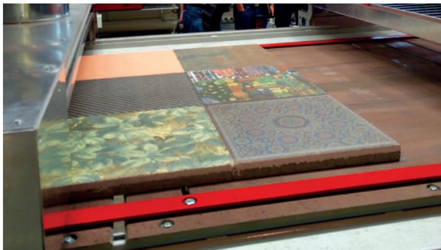
Плиты с напечатанным изображением перед нанесением запечатывающего состава
