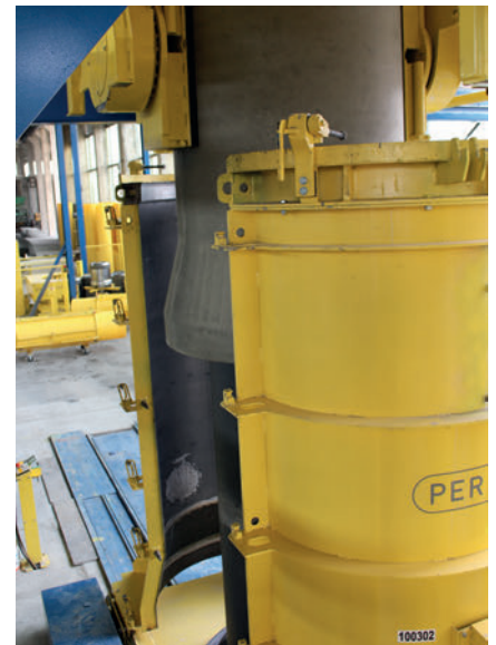
После затвердения в форме производится распалубка и монтаж коннекторов на соответствующем конце трубы
