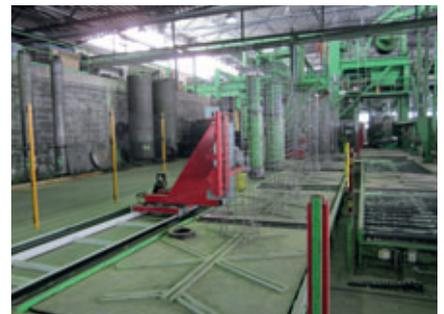
Il robot di prelievo trasporta le gabbie di armatura all'impianto a carosello di bancali della macchina per tubi, depositandole su un bancale messo a disposizione.
