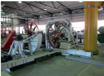
Le due ruote della macchina VTA sono sincronizzate elettronicamente, la saldatura inverter realizzata da Progress assicura qualità ed efficienza.
