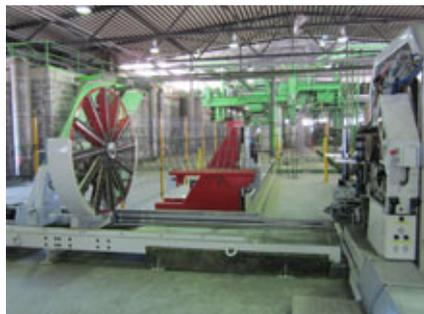
Dopo la produzione le gabbie di armatura ultimate vengono prelevate automaticamente.
