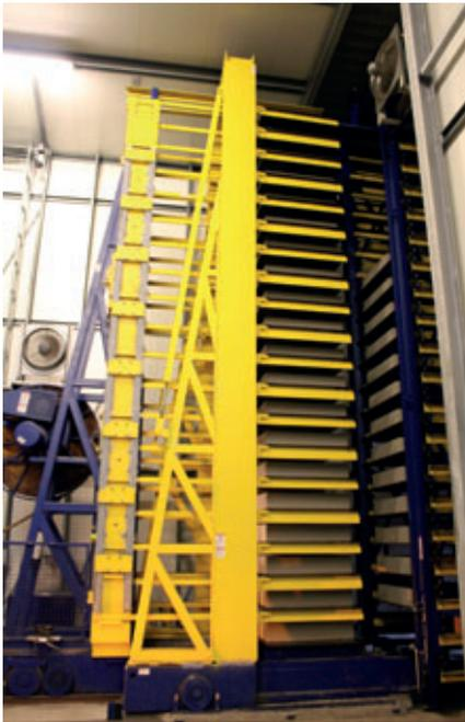
*Sul lato di essiccazione davanti al discensore è stato installato un carrello multi-forche tamponone.*
