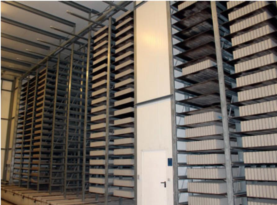
La camera di maturazione installata da HS Anlagentechnik alla Rewa è formata complessivamente da 16 camere di 20 piani ciascuna e da un'ulteriore camera vuota.
