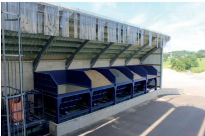
*I cinque silos degli aggregati per il miscelatore del calcestruzzo per rivestimento*
