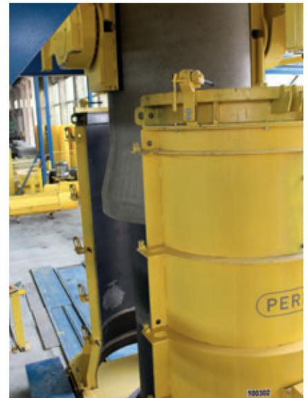
*In seguito all'indurimento nello stampo, i tubi in calcestruzzo vengono estratti e i connettori montati su un'estremità del tubo.*
