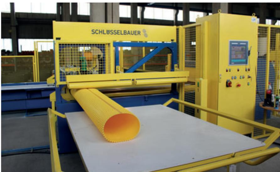
*I fogli di liner vengono saldati in modo completamente automatico per formare cilindri a tenuta.*
