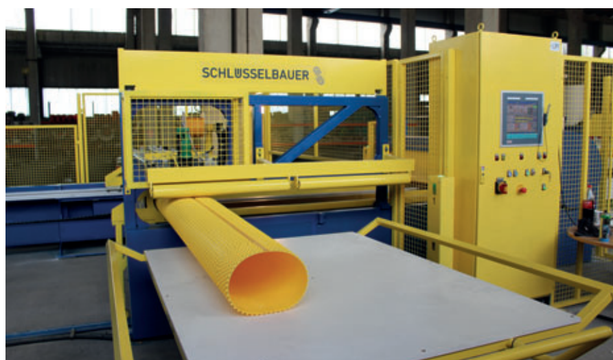
Les bandes de liner sont soudées de façon totalement automatisée pour constituer des cylindres étanches.
