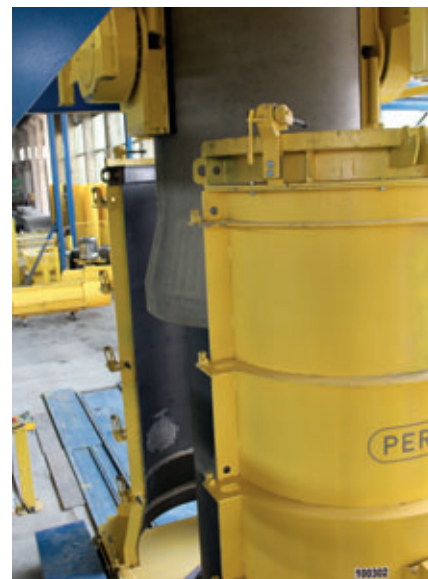
Une fois durcis les tuyaux béton sont démoulés et un connecteur est placé à chaque extrémité.
