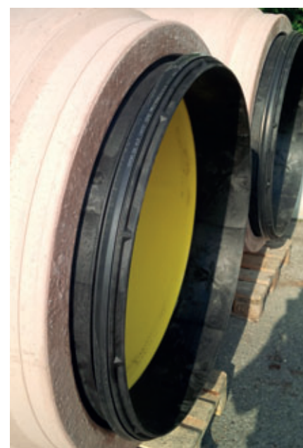
Les extrémités des tuyaux avec revêtement intérieur sont élargies de façon à ce que les connecteurs puissent être montés sans provoquer de resserrement du diamètre du tuyau.
