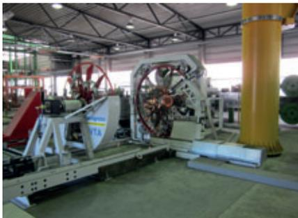
Les deux roues de la VTA sont synchronisées électroniquement, le soudage à moyenne fréquence Progress garantit la qualité et l'efficacité.
