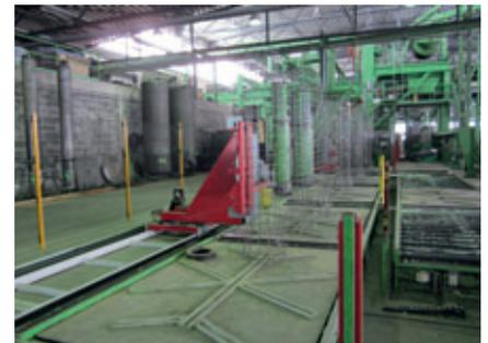
Le robot de prélèvement achemine les cages d'armature jusqu'au circuit de palettes et les dépose sur la palette préparée.
