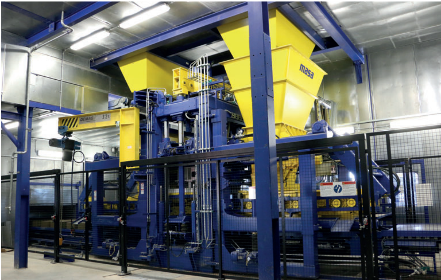
Installation de production de blocs en béton Masa XL 9.1
