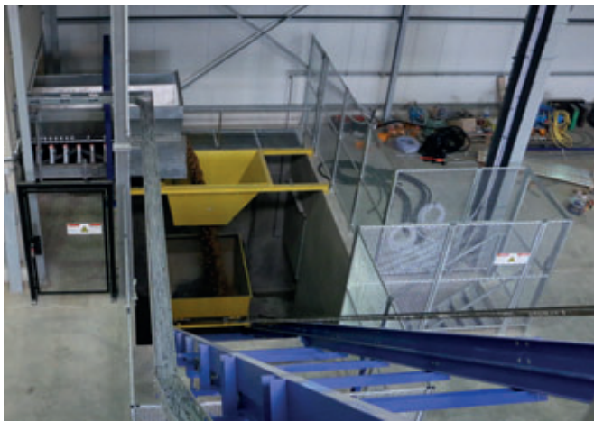
Cet élévateur est équipé d'un système de démarrage tout en douceur et apporte les granulats au niveau de malaxage supérieur.
