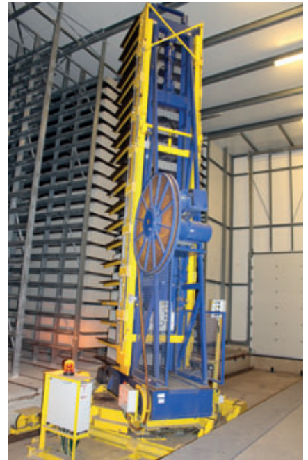
Le chariot transbordeur est équipé d'un dispositif de réglage du mât de levage permettant ainsi une utilisation optimale des planches, lorsqu'un étage sur deux est utilisé
