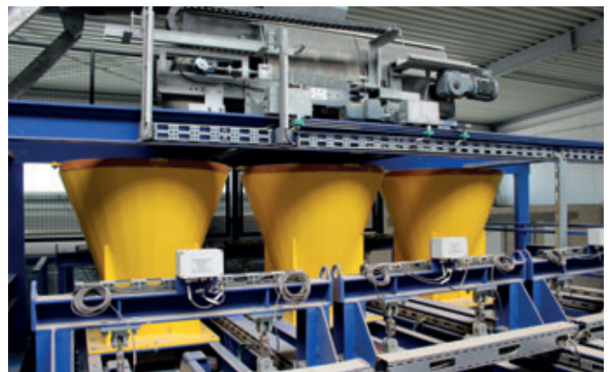
Système Color-Mix composé de 3 silos et de bandes de dosage mobiles
