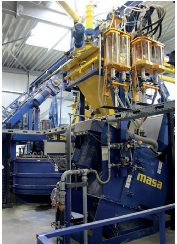
Mélangeur de béton de remplissage PH3000/4500 (à l'arrière) et mélangeur de béton de parement S350/500
