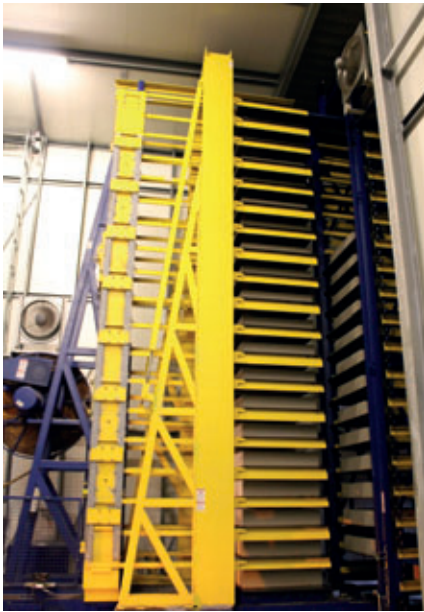
Côté sec, un chariot transbordeur tampon a été installé devant le descenseur.
