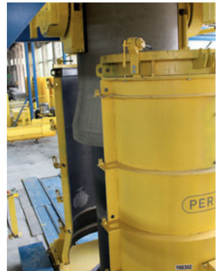
Tras el endurecimiento en el molde, los tubos de hormigón se desencofran y los elementos de conexión se montan en el extremo de tubo según corresponda.
