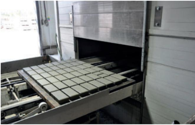
Los productos de hormigón frescos llegan a la cámara de curado transcurridos 30 segundos después de la fabricación, se introducen por un pequeño hueco ajustable de la pared, de este modo no se evapora humedad del hormigón.
