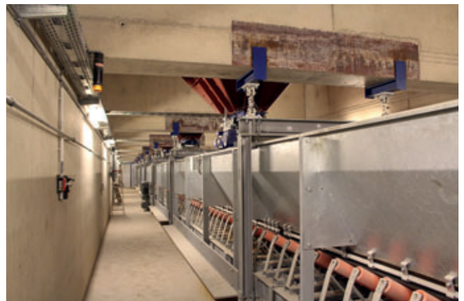
Los áridos son dosificados desde los silos a una cinta transportadora que los transporta al cangilón.
