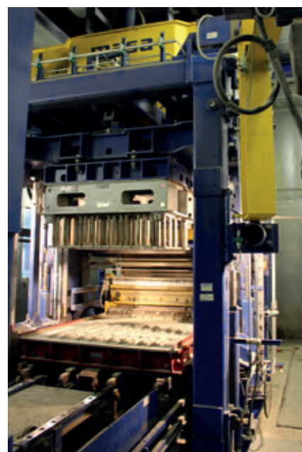
Para el cambio de molde automático, la máquina cuenta con una grúa de cambio de molde.
