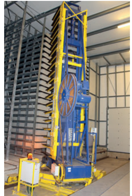
El carro multiforca está equipado con un ajuste de mástil elevador para el aprovechamiento óptimo de la bandeja al utilizar cada segundo nivel
