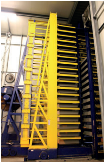
En el lado seco se instaló antes del descensor un carro multiforca para retener temporalmente las bandejas.
