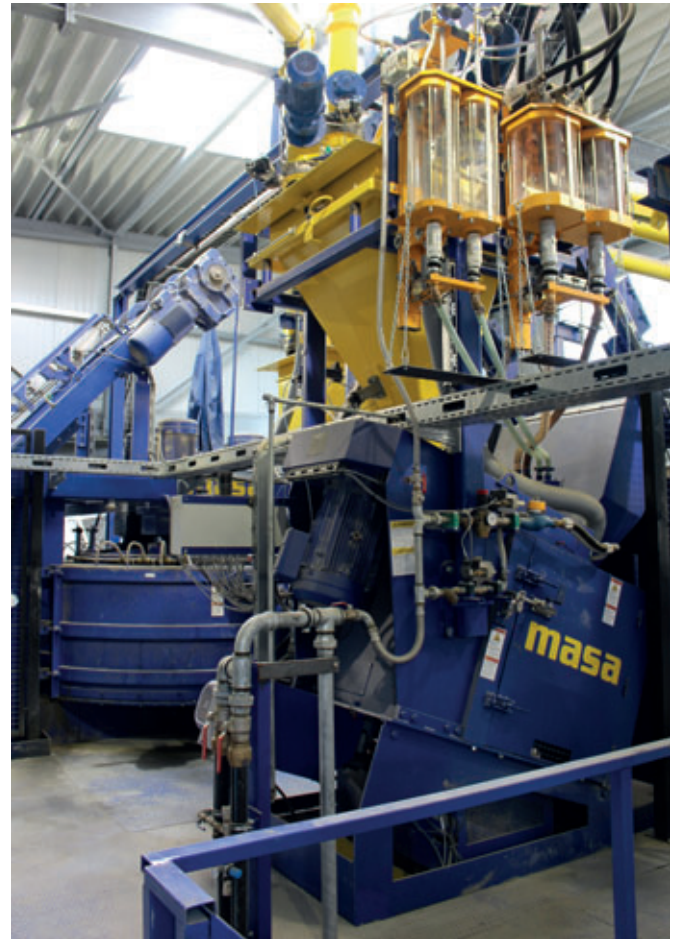
Mezcladora de hormigón monocapa PH3000/4500 (atrás) y mezcladora de hormigón bicapa S350/500
