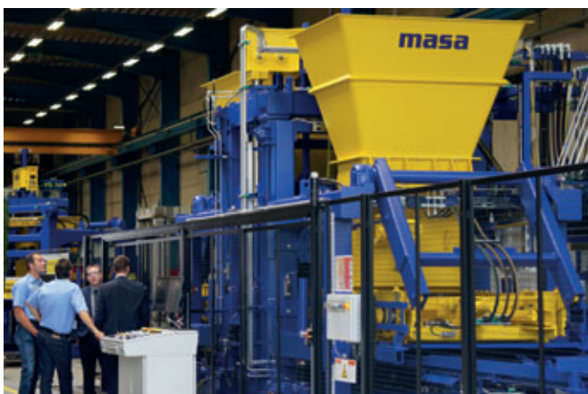
Ein besonderer Anziehungspunkt waren die Maschinenvorführungen – Neben der Masa Betonsteinfertigungsmaschine XL 9.2, ...
