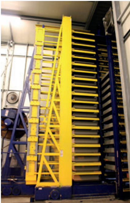
Auf der Trockenseite wurde vor der Senkleiter noch eine Pufferfahrzeuggruppe installiert.
