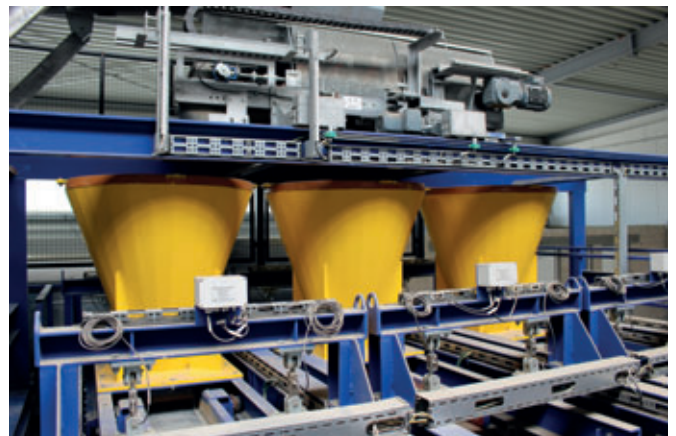
Color-Mix-System mit 3 Silos und verfahrbaren Dosierbändern
