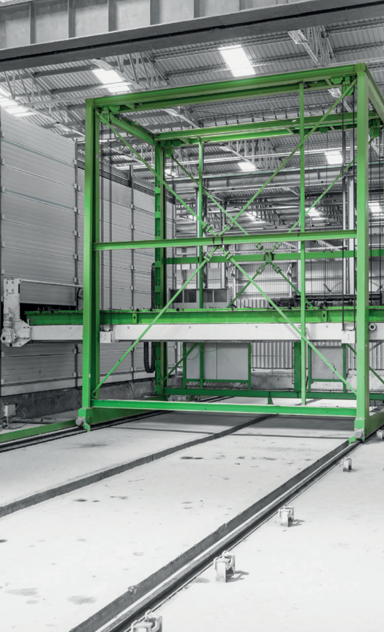
Недавно BG SCTPL открыла три линии Elematic на заводе в Дели для производства целевых плит перекрытия, стен и колонн 3S
