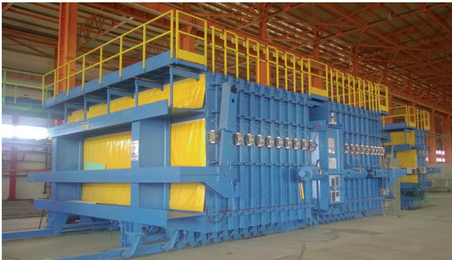
На новом ДСК в Костанайе для производства вентиляционных шахт используется кассетная форма. После выдержки бетонных элементов слегка зауженные сердечники не вытягиваются, а просаживаются на несколько сантиметров для упрощения процесса распалубки. Такой подход позволяет сэкономить средства и место
