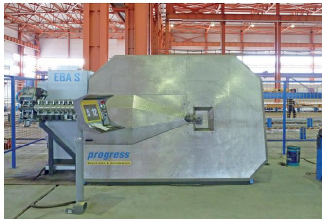
Автоматическая установка серии EBA S служит для высокоточного производства арматурных хомутов и стержней
