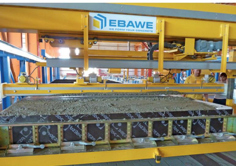
Вибробрус уплотняет и заглаживает поверхность свежеложенной бетонной смеси до требуемой высоты
