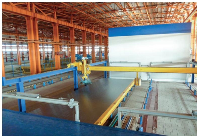
После этапа предварительной выдержки поверхность стеновых сэндвич-панелей затирается заглаживающим устройством
