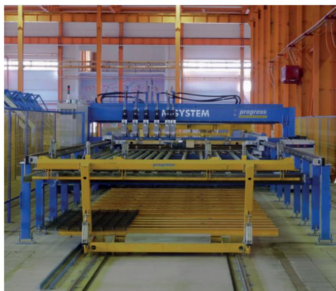
Сварочная установка M-System Evolution получает все необходимые данные из системы ebos. Арматурные сетки изготавливаются в точном соответствии с полученными данными
