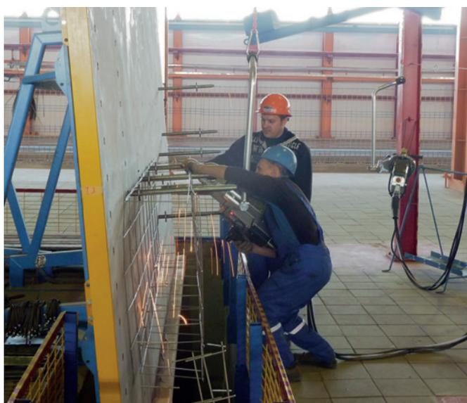
Вертикальный сварочный робот для изготовления арматурных каркасов
