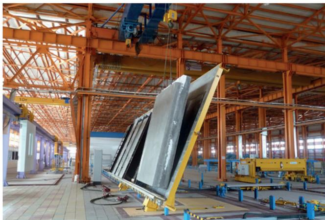
Съем готовой стеновой сэндвич-панели при помощи опрокидывающего устройства
