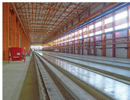
Отдельный цеховой пролет для производства преднапряженных плит перекрытий на нескольких дорожках
