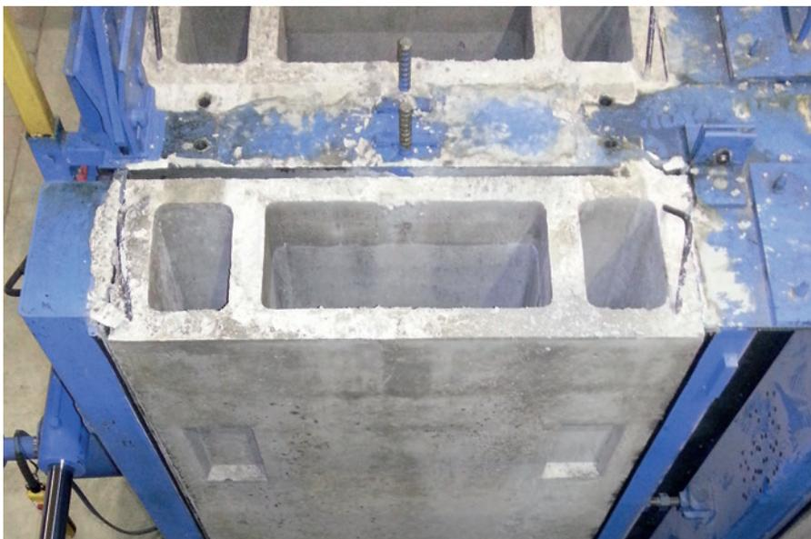
Стационарное производство перегородок, вентиляционных шахт и лестничных маршей в кассетной форме на ДСК ТОО «Костанай - МБИ»
