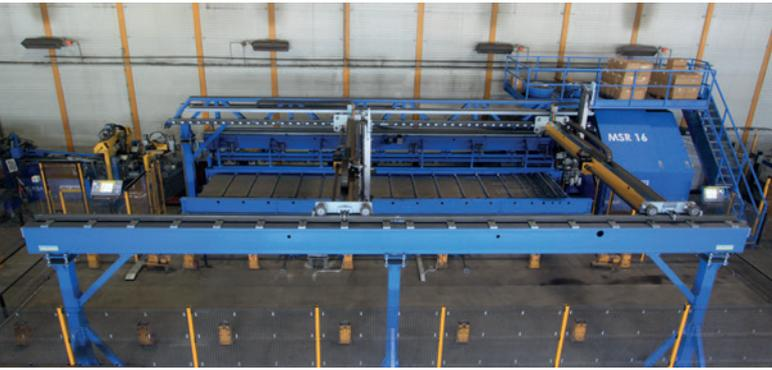
Новая линия по выпуску арматуры: станок VGA Versa (сзади слева), установка MSR16 2BK (позади) и робот-укладчик арматуры (на переднем плане)
