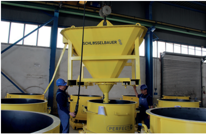
Бетонирование осуществляется посредством бады объемом 2 м 3
