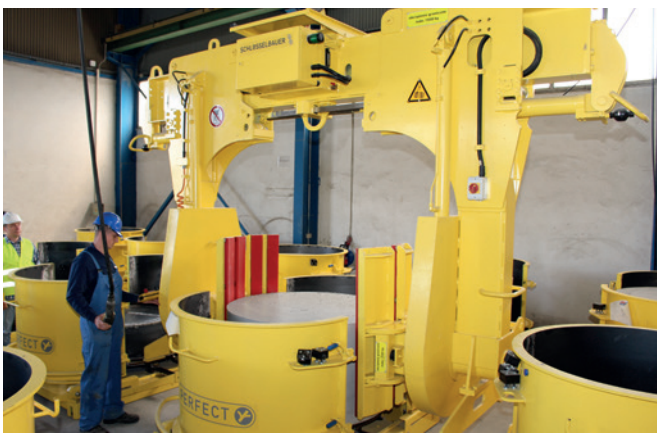
Поворотная траверса для кантования элементов весом до 9 т
