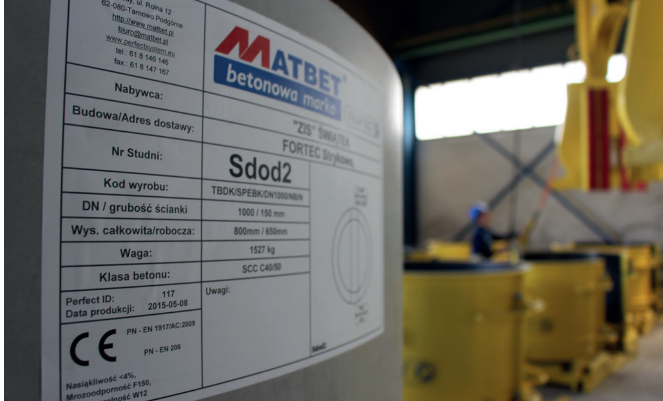
Готовые кольца с дном снабжаются самоклеющимся ярлыком с указанием всех необходимых данных и параметров
