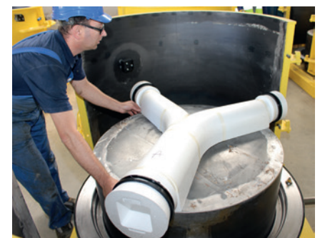
Укладка готового негатива лотка в стальную форму
