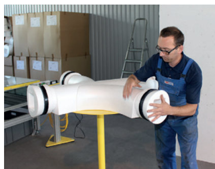
Установка вкладышей приточных патрубков с интегрированным уплотнением
