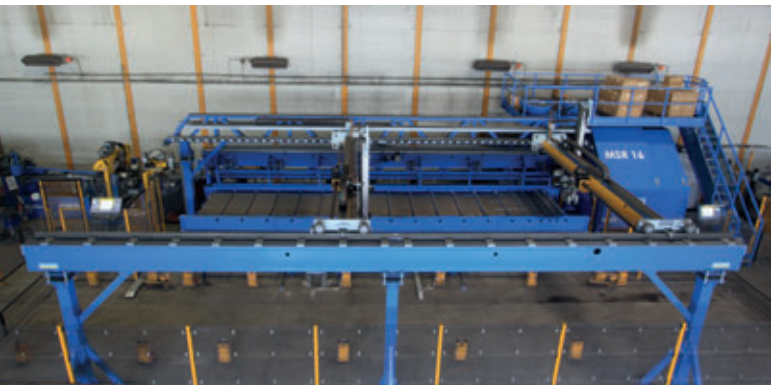
La nuova linea per la produzione di armature: VGA Versa (dietro a sinistra), MSR16 2BK (dietro) e il robot d'armatura (davanti).
