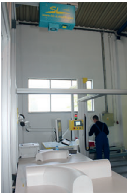
Per controllare il posizionamento preciso dei singoli componenti vi è una tavola di proiezione laser che mostra costantemente tutte le linee di produzione dei pozzetti.
