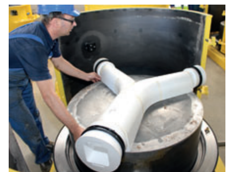
Inserimento di un negativo per canali prefinito in uno stampo di acciaio
