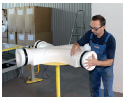
Installazione degli stampi per raccordi con guarnizioni premontate
