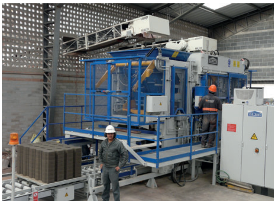
Blocchiera multistrato Zenith 844 SC per masselli con calcestruzzo di rivestimento
