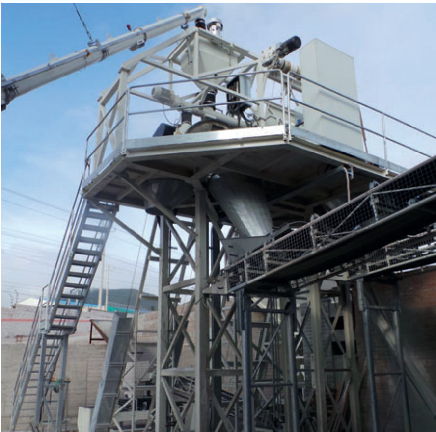
Miscelatori e trasportatori a nastro Euromecc per alimentare la blocchiera multistrato
