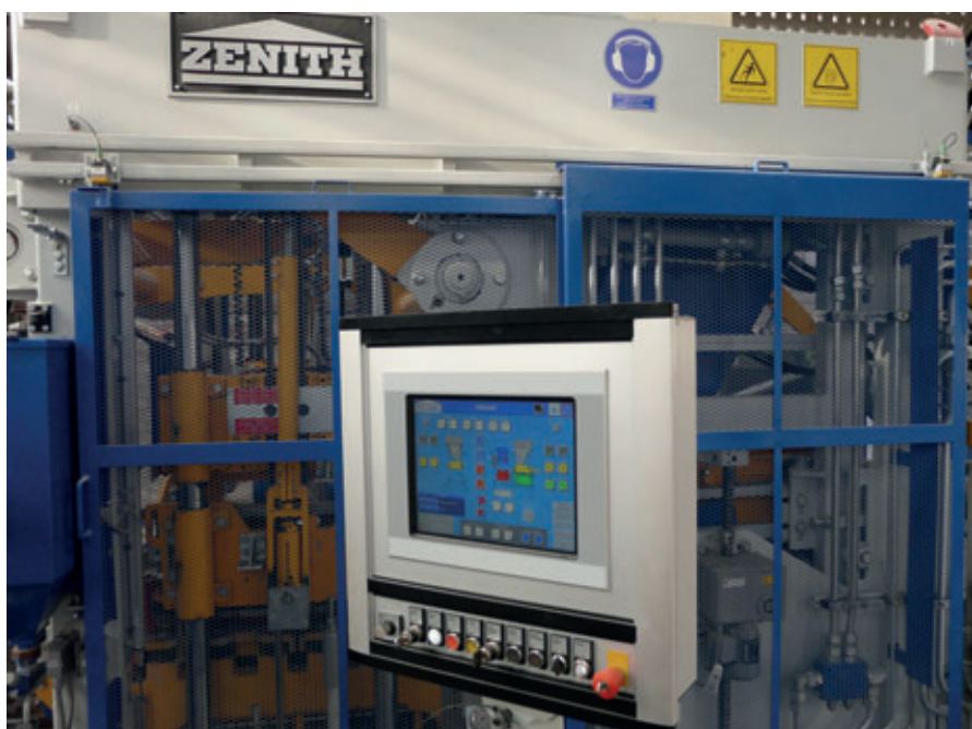
Comando completamente automatico della blocchiera multistrato Zenith 844 SC
