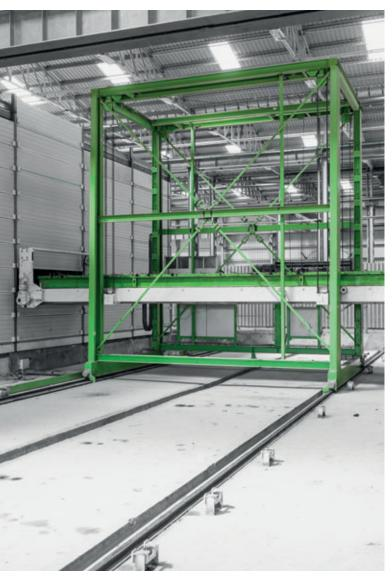
BGSCTPL ha recentemente installato tre linee di produzione di Elematic a Delhi per gli elementi prefabbricati in calcestruzzo: impianti a carosello per grandi elementi di solaio, pannelli speciali di parete e pilastri 3S.
