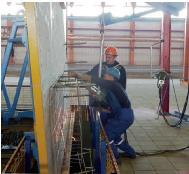
Manipolatore di saldatura verticale per saldare le gabbie d'armatura
