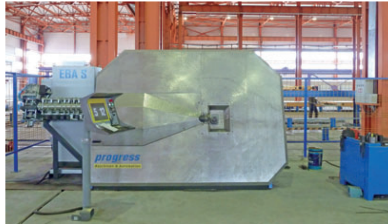
La staffatrice automatica della serie EBA S serve a produrre staffe e barre con elevata precisione.
