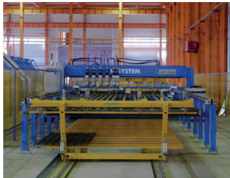
L'impianto di saldatura reti M-System Evolution riceve i dati necessari da ebos. Le reti d'armatura sono prodotte just-in-time ed esattamente secondo le prescrizioni necessarie.
