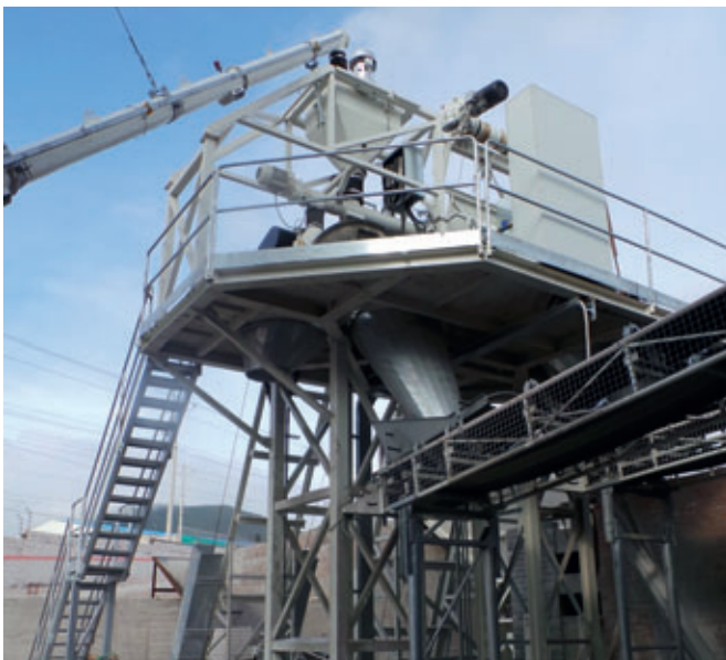
Mélangeurs et convoyeurs à bande de la société Euromecc pour l'alimentation de la machine de production de blocs multicouches
