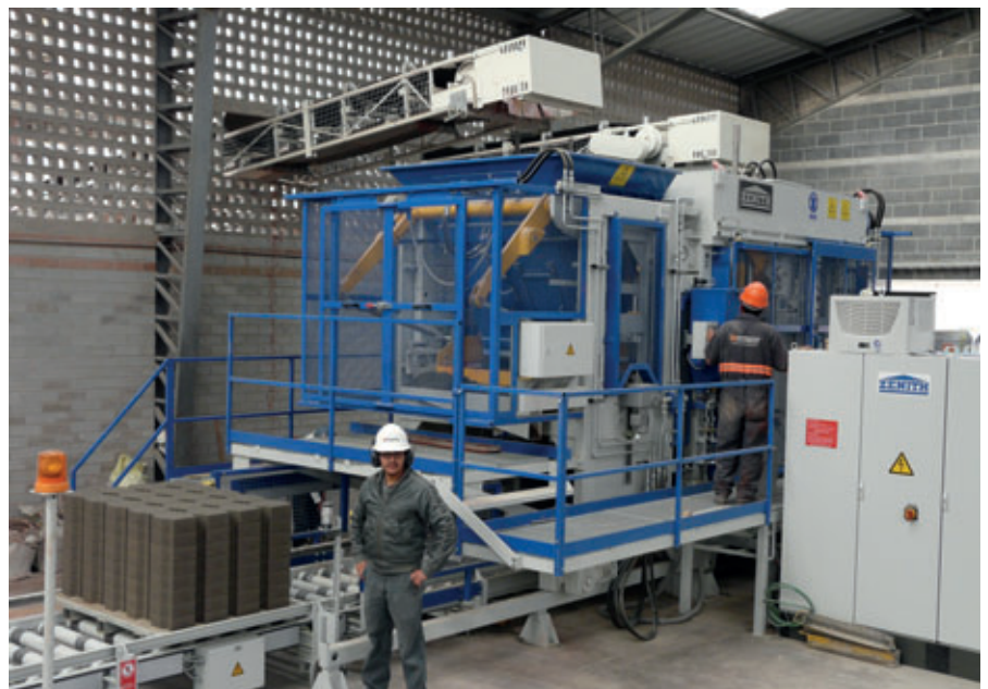
Machine de production de blocs multicouches Zenith 844 SC pour pavés à base de béton de parement
