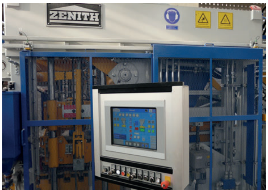
Commande totalement automatique de la machine de production de blocs multicouches Zenith 844 SC
