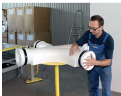
Positionnement final des réservations pour branchements tuyaux, réservations déjà pourvues de joints
