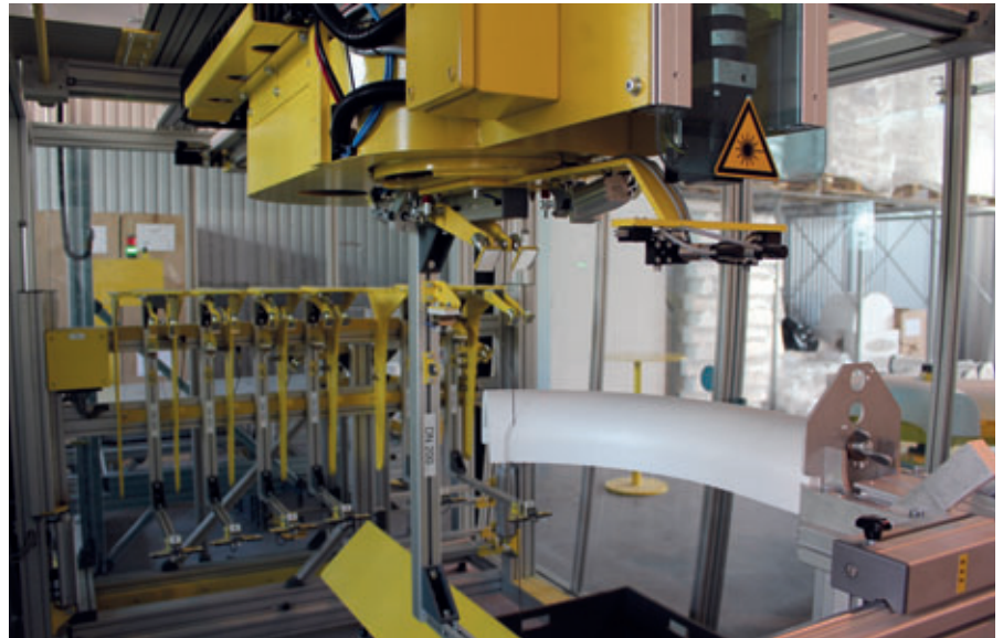
La découpe fait intervenir différentes scies à fil chaud fonctionnant en deux et trois dimensions.
