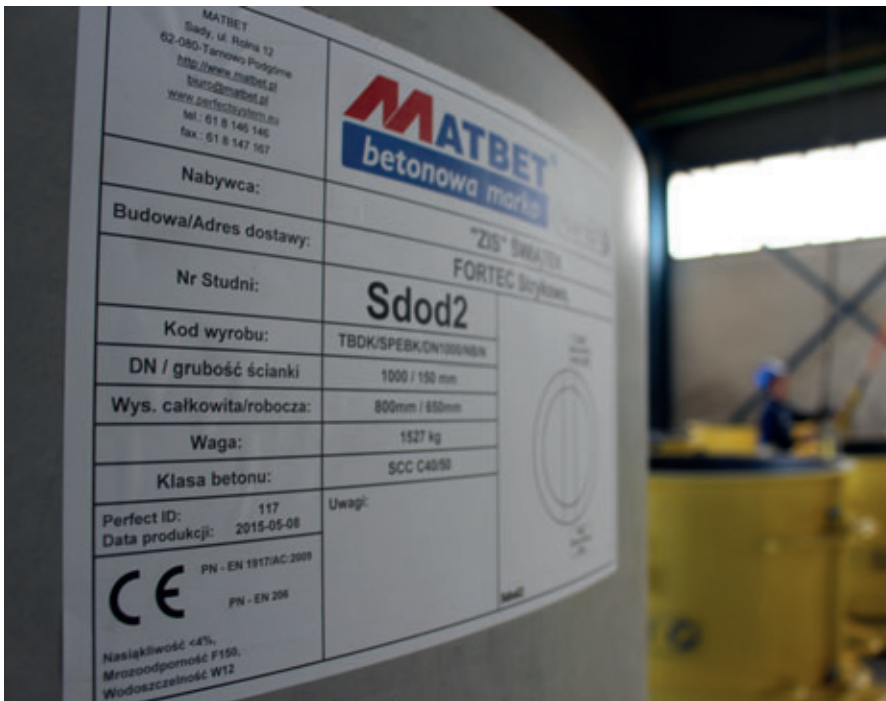
Un autocollant précisant tous les paramètres et les données du produit est appliqué sur les fonds de regards terminés.
